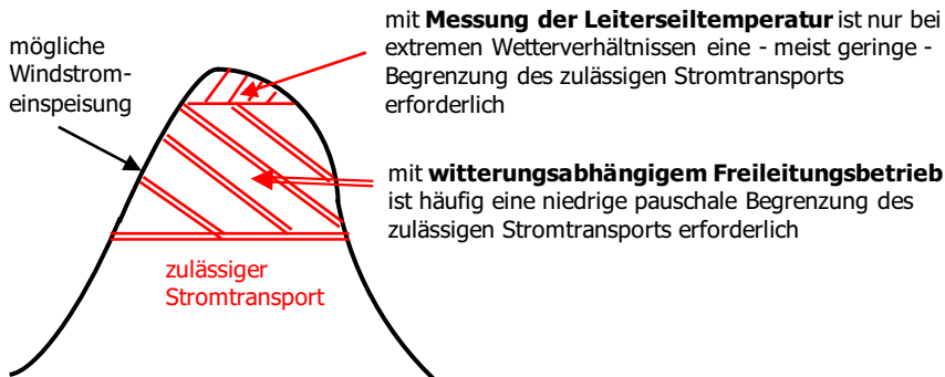
Abb. 7.1: Messung der Leiterseiltemperatur statt witterungsabhängigem Freileitungsbetrieb
